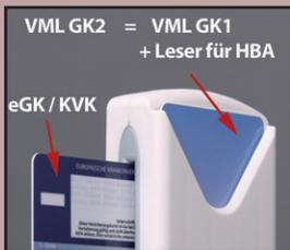
Das ZEMO VML-GK2 verfügt auf der Rückseite über eine zusätzliche Leseinheit. Diese ist erst für eine 2. Stufe der Gesundheitskarte notwendig. Das VML-GK1 kann hierfür später nachrüstet werden.
