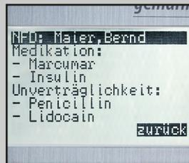
Die ZEMO VML-GK Lesegeräte verfügen über das, für die Anzeige künftiger Notfalldaten erforderliche, 8-zeilige Grafikdisplay. (Anmerkung: Die Funktionalität zur Anzeige von Notfalldaten ist für die 2. Stufe der Gesundheitskarte geplant.)
