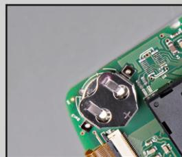
Der Datumsbaustein unseres Lesegerätes wird durch die Hauptbatterien gespeist. Sollten diese jedoch leer sein, läuft das Datum und die Uhrzeit bis zu 2 Jahre (durch die Pufferbatterie) weiter. Dadurch ist **sichergestellt**, dass die **Chipkarten** zum **korrekten Datum gespeichert** werden!
