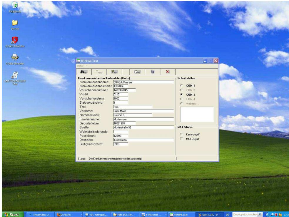
Beenden Sie das Testprogramm mit X. Nun ist das ORGA 6041 L eGK bereit für den Betrieb mit dem Praxisprogramm. Geben Sie dort in den Einstellungen für den Kartenleser den während der Installation angezeigten COM-Port ein.
