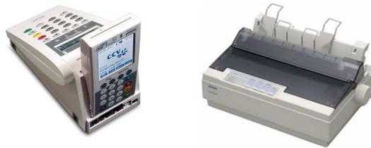
Für den Direktausdruck von Versichertendaten der elektronischen Gesundheitskarte kann das CARD STAR/medic2 mit dem Epson-Drucker über die serielle Druckerschnittstelle verbunden werden.
