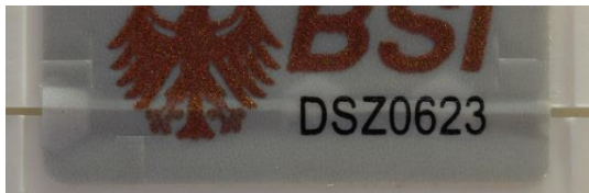
Abb. 3 (Siegel beschädigt, siehe helles Wabenmuster)
