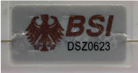
Abb. 4 (Siegel beschädigt, siehe eingerissene Kanten)
