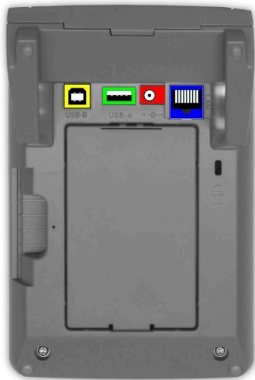
Abbildung 27: Anschlüsse auf der Unterseite des Gerätes
