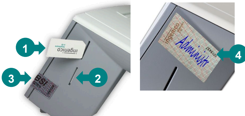
Abbildung 11: Die Kontaktiereinheiten 3 und 4 für die SMC-Karten
