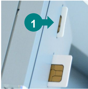
Abbildung 23: Einsetzen der SMC-Karten in die Kontaktiereinheit 3 und 4
