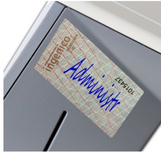
Abbildung 24: Die richtige Positionierung des Slotsiegels
