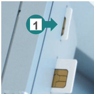
Abbildung 22: Einsetzen der SMC-Karten in die Kontaktiereinheit 3 und 4
