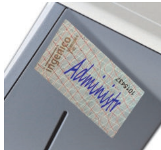
Abbildung 23: Die richtige Positionierung des Slot-siegels
