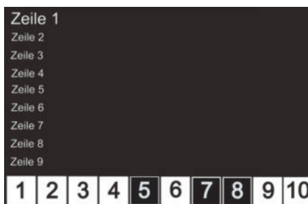
Abbildung 13: Aufbau des Grafikdisplays
