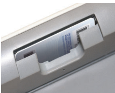
Abbildung 19: Der HBA in der Kontaktiereinheit 2
