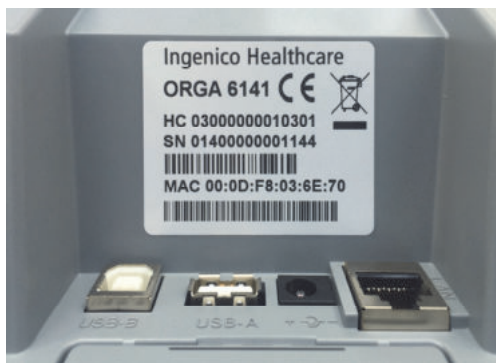
Abbildung 8: Typenschild mit Herstellercode HC 03000000010301
